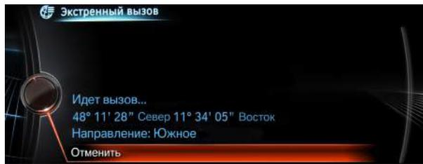
Автоматический экстренный вызов: автоматически при срабатывании датчиков столкновения или подушек безопасности.
