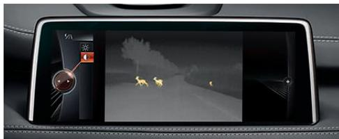
□ Система ночного видения BMW с динамическим точечным освещением с большого расстояния распознает в темноте людей и крупных животных и направляет свет на обнаруженный объект. Тепловизионная камера в "ноздрях" передает изображение людей и животных на контрольный дисплей.
