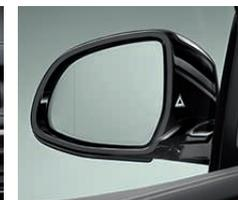
□ Система помощи при перестроении распознает (на скорости выше 30 км/ч) автомобили, находящиеся в "мертвой зоне", и предупреждает об этом с помощью визуального сигнала на зеркале заднего вида.
