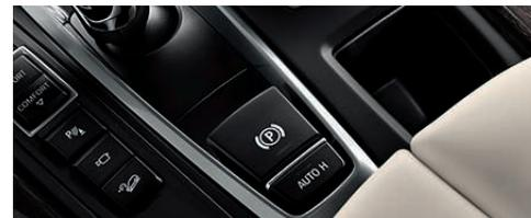
■ **Стояночный тормоз с функцией Automatic Hold** удобно включается кнопкой на центральной консоли. Тормоз отпускается при нажатии педали акселератора. Функция Automatic Hold помогает водителю, например, при движении в пробках или при трогании с места на уклонах, предотвращая непроизвольное скатывание вперед или назад.
