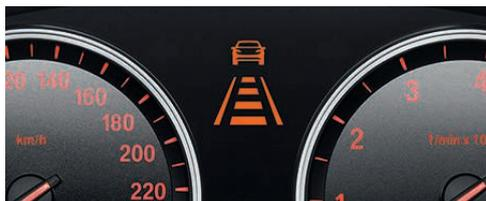
□ Система Ассистент вождения Plus включает в себя ряд функций предупреждения о столкновении и системой слежения за разметкой активной круиз-контроль с функцией Stop&Go (на илл.), а также систему помощи при движении в пробках (в России не предлагается). Тем самым система Driving Assistant Plus при движении по автомагистралям повышает безопасность и комфорт. Условием является наличие опционального навигационного пакета ConnectedDrive.
