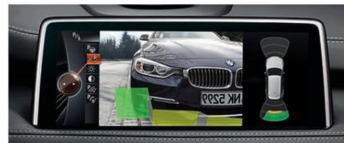
□ Камера заднего вида позволяет удобнее ориентироваться при движении задним ходом на парковке и на скоростях до 20 км/ч. Она отображает на контрольном дисплее пространство позади автомобиля.
