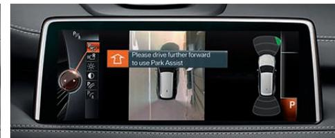
□ Ассистент парковки облегчает парковку параллельно проезжей части. Подходящие свободные места отображаются и выбираются на контрольном дисплее. При длительном нажатии кнопки система берет на себя управление процессом парковки, включая выбор передачи, работу рулем, а также педалями акселератора и тормоза.
