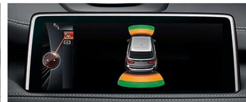
□ Сигнализация аварийного сближения при парковке (PDC) спереди и сзади облегчает парковку и маневрирование на самом тесном пространстве. Система включается автоматически, а о расстоянии до препятствия информируют звуковые сигналы, а также изображение на контрольном дисплее (серийно для M50d).
