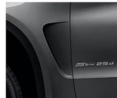
■ **Воздуховоды** в передних колесных арках направляют воздушный поток у передних колес. Таким образом снижается аэродинамическое сопротивление и сокращаются расход топлива и выбросы CO<sub>2</sub>.
