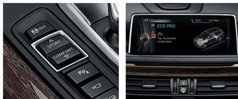
■ Переключатель режимов движения, включая режим ECO PRO, позволяет выбрать стандартный режим Comfort, ориентированный на экономичность режим ECO PRO или режим Sport, обеспечивающий повышенную динамику. В режиме ECO PRO производится адаптация к текущим условиям движения характеристик работы педали акселератора, коробки передач и отопителя/кондиционера.
