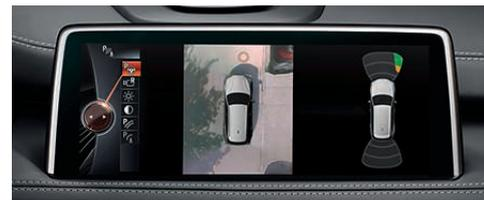
□ Система кругового обзора помогает при парковке и маневрировании на тесном пространстве. Для этого на контрольном дисплее отображается вид сверху пространства сбоку и позади автомобиля. Кроме того, система бокового обзора обеспечивает обзор движения в поперечном направлении на выездах и перекрестках с плохой видимостью.
