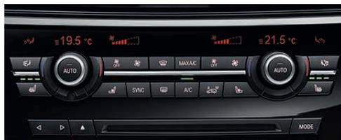
**Двухзонный климат-контроль** с раздельной авторегулировкой подачи воздуха и температуры для водителя и переднего пассажира. Включает в себя микрофильтр, датчик запыления, систему автоматического управления рециркуляцией (AUC), а также автономную вентиляцию и функцию использования остаточного тепла двигателя.
