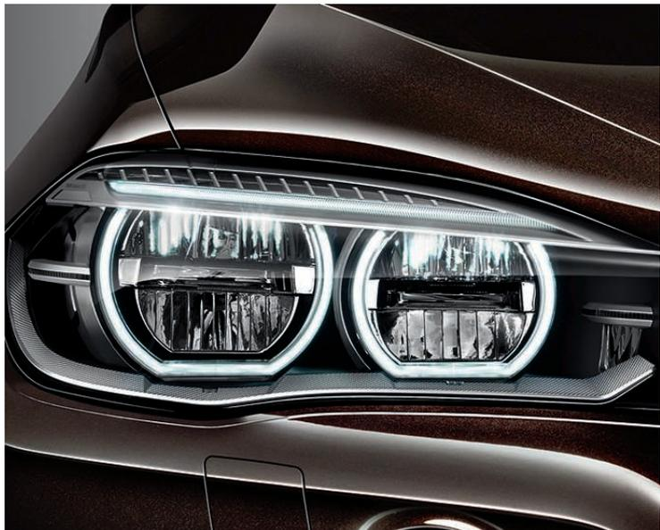
□ **Адаптивные светодиодные фары** включают в себя акцентирующую подсветку, ближний и дальний свет, неслепящую систему управления дальним светом, светодиодные противотуманные фары, лампы освещения поворотов, указатели поворота, дневной свет и адаптивный поворотный свет с регулируемым распределением света для оптимального освещения дороги и лучшего обзора ночью.
