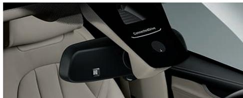
■ **Датчик дождя, включая управление ближним светом:** в зависимости от интенсивности дождя автоматически включает стеклоочистители и регулирует частоту их работы.
