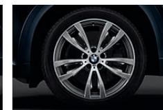
□ 20-дюймовые легкосплавные диски M Double-spoke 469 M с разноразмерными шинами, спереди 10 J x 20 с шинами 275/40 R 20, сзади 11 J x 20 с шинами 315/35 R 20.
