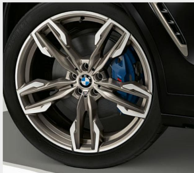
□ 21" легкосплавные диски M Double-spoke 718 M цвета "Серый Церий матовый" с разноразмерными шинами, полированные. Передние диски 8,5J x 21 с шинами 245/40 R21, задние диски 9,5J x 21 с шинами 275/35 R21.<sup>1</sup>
