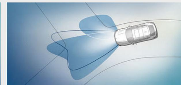
□ **Адаптивные светодиодные фары** включают в себя светодиодный ближний и неослепляющий дальний свет (BMW Selective Beam), а также светодиодные указатели поворотов. В оснащение также входит функция освещения поворотов, дневные ходовые огни и адаптивные фары с регулируемым световым потоком для эффективного освещения дороги и обеспечения лучшей видимости в темное время суток.
