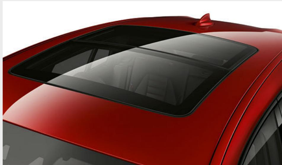
□ В открытом положении панорамная стеклянная крыша обеспечивает дополнительный приток свежего воздуха в салон автомобиля. В закрытом положении она наполняет салон светом и создает ощущение простора. Она открывается и закрывается полностью автоматически одним нажатием кнопки или с помощью дистанционного управления, может сдвигаться и подниматься, а также включает в себя солнцезащитную шторку и ветроотражатель.
