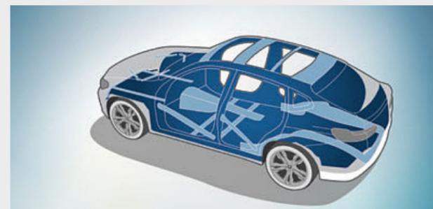
■ **Функциональная конструкция каркаса кузова** включает в себя особую систему балок и узловых соединений, детали которых выполнены из высокопрочных материалов для обеспечения максимального уровня пассивной безопасности в случае фронтального, бокового или попутного столкновения.
