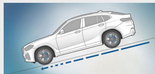
■ **Опциональная система помощи на спуске** в моделях xDrive – система, активация которой гарантирует, что автомобиль может самостоятельно и безопасно преодолеть крутой спуск со скоростью прогулочного шага без необходимости нажатия на педаль тормоза.
