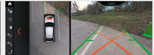
□ Ассистент парковки Plus упрощает маневрирование автомобиля при парковке. Он включает в себя систему кругового обзора, включая вид сверху, сигнализацию аварийного сближения (PDC), а также систему помощи при перпендикулярной парковке, функцию экстренного торможения при парковке и ассистент парковки, обеспечивающий полностью автоматическую парковку как параллельно, так и перпендикулярно дороге.
