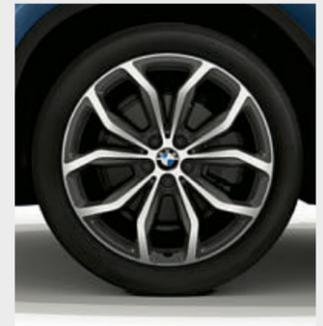
□ 20" M легкосплавные диски Y-spoke 695 M с разноразмерными шинами, шлифованные. Передние диски 8J x 20 с шинами 245/45 R20, задние диски 9,5J x 20 с шинами 275/40 R20.
