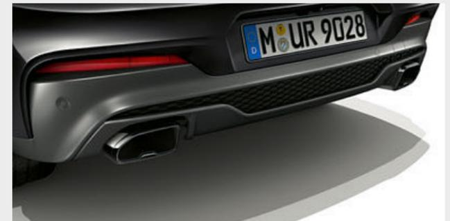
Аэродинамический пакет M подчеркивает атлетичность автомобиля и улучшает его аэродинамические качества. В пакет входят передний бампер с увеличенными воздухозаборниками, уникальные боковые облицовки порогов и задний бампер с диффузором.
