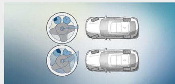
■ **Адаптивное спортивное рулевое управление**, включая сервоуправление, делает рулевое управление более отзывчивым и "острым", а также уменьшает усилие на рулевом колесе, когда его требуется повернуть на большой угол. При определении системой большого угла поворота рулевого колеса изменяется передаточное число рулевого механизма. Благодаря этому улучшаются управляемость и устойчивость при движении с большой скоростью и уменьшается усилие на рулевом колесе при выполнении парковки и в поворотах.
