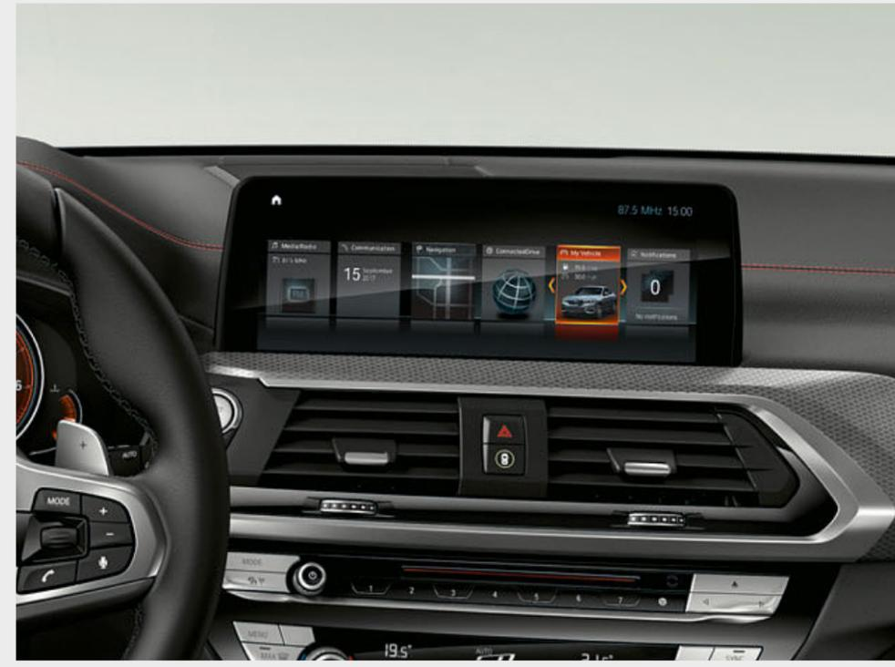
□ Навигационная система Professional с жидкокристаллическим цветным дисплеем диагональю 10,25" включает в себя радио BMW Professional, DVD-проигрыватель, а также жесткий диск объемом 20 Гб для хранения аудиофайлов. Управлять системой можно с помощью сенсорного контроллера iDrive, с сенсорного дисплея, а также с помощью семи программируемых клавиш.
