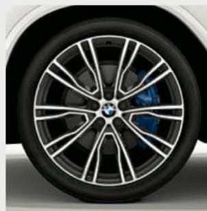
□ 21" легкосплавные диски BMW Individual, V-spoke 726 I Bicolor Orbit Grey с разноразмерными шинами, шлифованные. Передние диски 8,5J x 21 с шинами 245/40 R21, задние диски 9,5J x 21 с шинами 275/35 R21.
