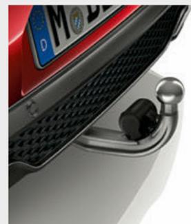
□ Тягово-сцепное устройство с электроприводом шаровой головки и системой стабилизации прицепа рассчитано на буксировку прицепов массой до 2400 кг.
