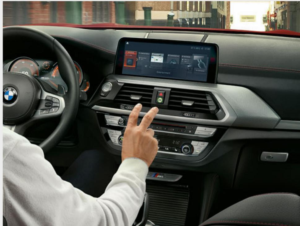
□ Система управления жестами BMW позволяет управлять определенными функциями автомобиля легким движением руки. Так, например, система распознает жесты "указать" или "смахнуть" для приема или отклонения входящего вызова, а также вращательное движение указательного пальца для регулировки громкости.
