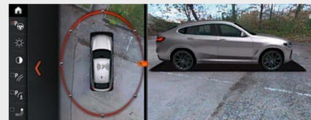
□ Система кругового обзора<sup>5</sup> формирует изображения с помощью камеры заднего вида, вида сверху, панорамного вида и, трехмерного вида. Камеры в зеркалах заднего вида, а также в передней и задней частях автомобиля обеспечивают изображение с охватом 360°. Панорамный вид делает движение более безопасным при приближении к перекресткам и при съезде с автомагистралей. В этом режиме на контрольный дисплей выводятся изображения транспортных потоков, движущихся слева и справа от автомобиля.
