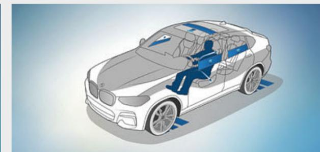
□ **Активная защита** является системой превентивной безопасности в рамках BMW ConnectedDrive. В критических ситуациях она предупреждает водителя и подтягивает ремни безопасности. При наличии электропривода сидений система поднимает спинки в вертикальное положение, а также закрывает окна и люк в крыше. После аварии система автоматически задействует тормоза автомобиля до момента его полной остановки.
