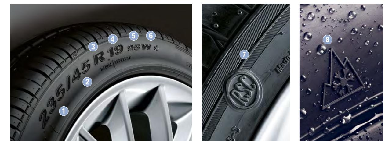
**1** Ширина шины в миллиметрах. **2** Высота профиля в процентах. **3** Тип конструкции шины (R — радиальная).
